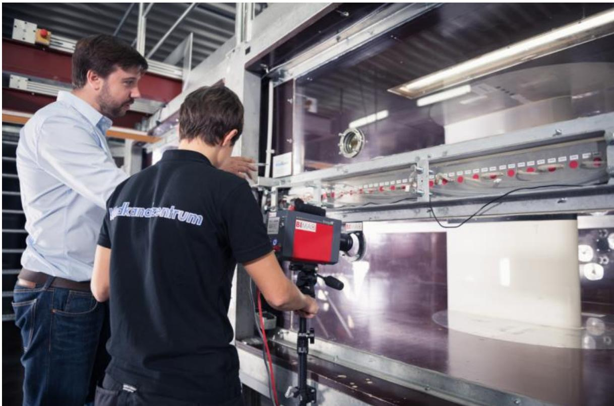
Nicholas Balaesque (links) leitet in Bremerhaven den Großwindkanal. Mit 80 hoch empfindlichen Mikrofonen sowie zwei Hochgeschwindigkeits-Thermografiekameras werden die Messungen vorgenommen. © Urs Siedentorp für Deutsche WindGuard GmbH
