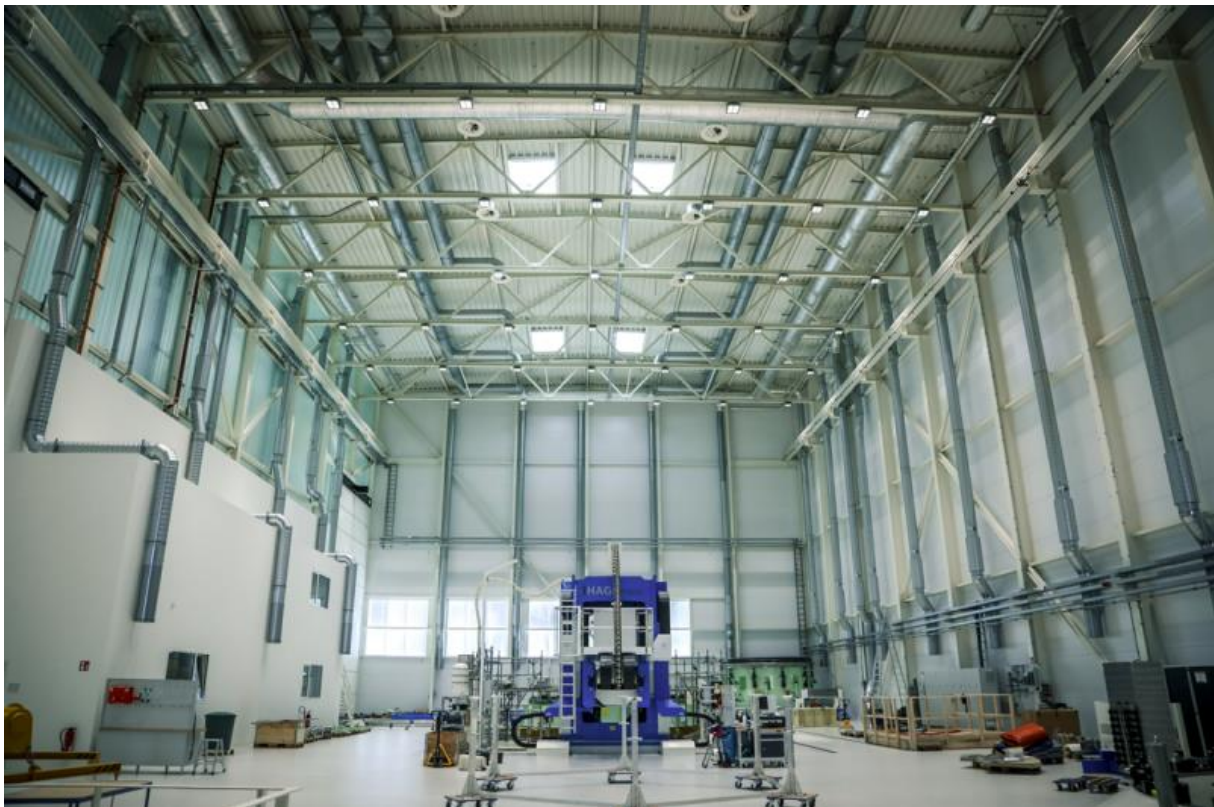
Etwa sechs Meter hoch, vier Meter breit, gut 40 Tonnen schwer: Kaum zu glauben, dass dieser Koloss für filigrane Arbeiten an der Trägerrakete Ariane 6 ausgelegt ist. © WFB/Focke Strangmann
